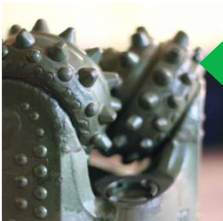
THE «BLUE» TRICONE BIT : SEALED BEARING
